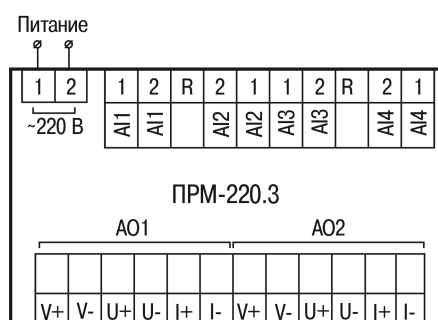
Рисунок 5.3 – Назначение контактов клеммника прибора с питанием 230 В
