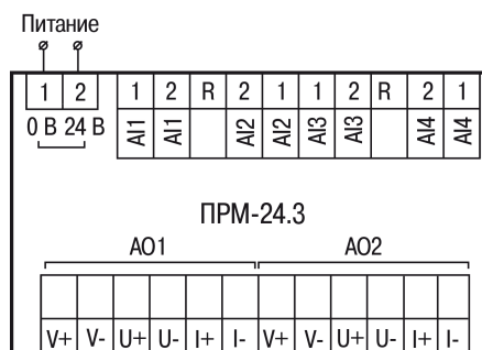
Рисунок 5.2 – Назначение контактов клеммника прибора с питанием 24 В
