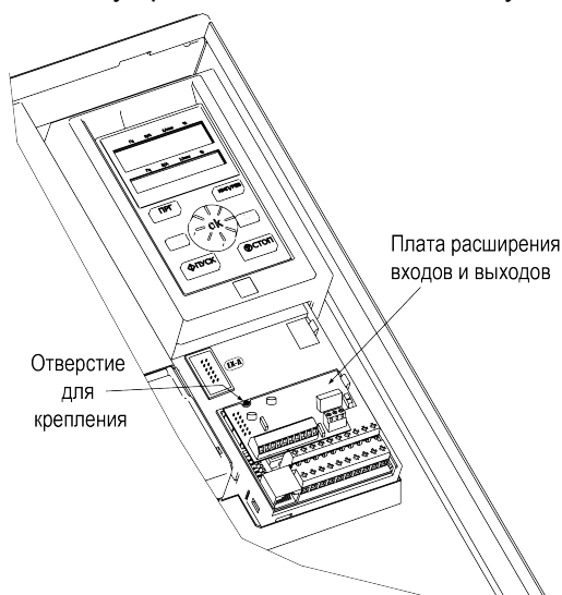
Рисунок 7.27 – Монтаж платы расширения входов и выходов
