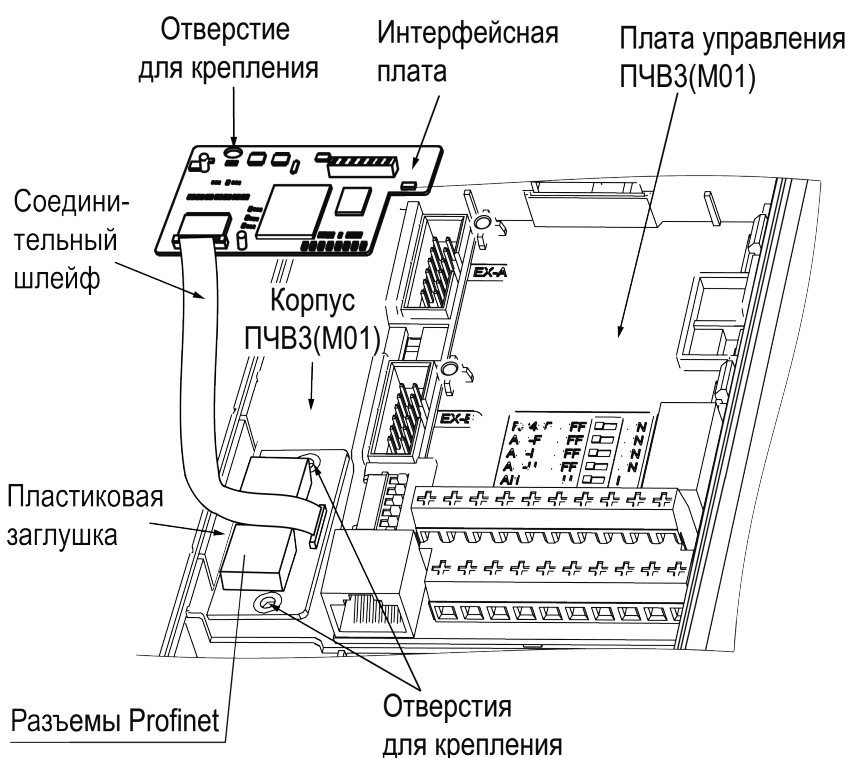
Рисунок 7.21 – Монтаж платы на преобразователях частоты мощностью 5,5 – 45 кВт
