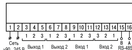
Рисунок 5.2 – Назначение контактов клеммника TPM212-H, -Щ1 и -Щ2
